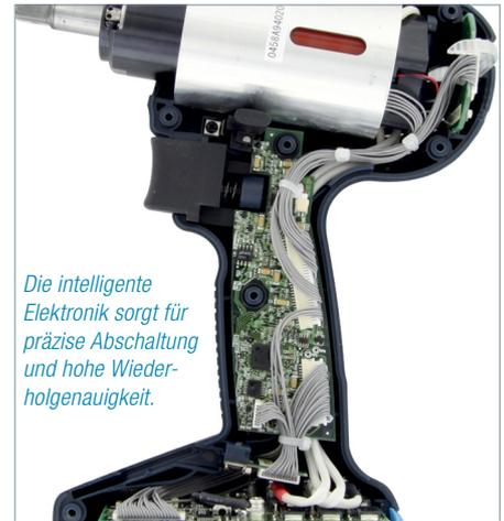
Die intelligente Elektronik sorgt für präzise Abschaltung und hohe Wiederholgenauigkeit.
