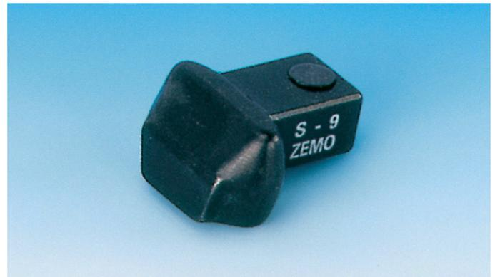
Anschweißadapter mit Rechteckanschluss 9×12 mm bzw. 14×18 mm. Ideal, wenn man ein kundenspezifisches Werkzeug herstellen möchte, das mit einem Rechteck-Drehmomentschlüssel benutzt werden soll.
