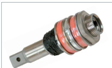
Abb.: Antriebsachse mit Dehnmessstreifen
